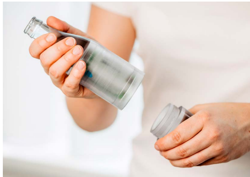
Датчик, вмонтований у муляж скляної емкості, фіксує можливі небезпечні точки на лінії
