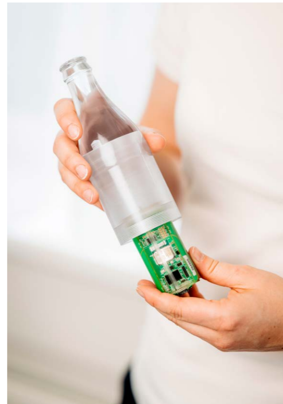
Датчик, вмонтований у муляж скляної емкості, фіксує можливі небезпечні точки на лінії
