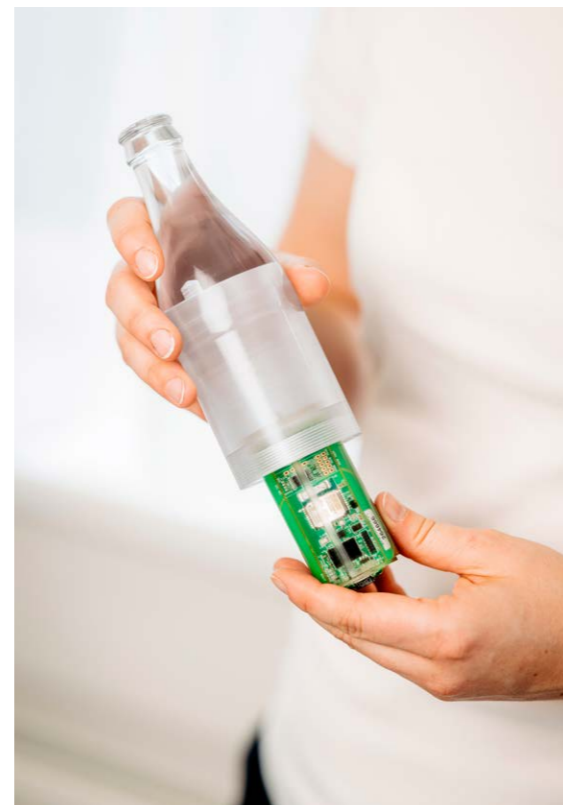
Snímač vložený v makete registruje potenciálne nebezpečné miesta pre sklenenú nádobu na linke.
