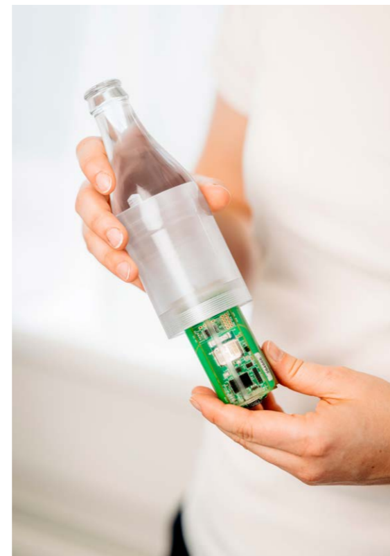
Senzorul introdus în model înregistrează potențiale puncte de pericol pentru recipientul de sticlă din linie.
