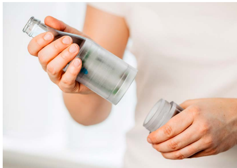
Senzorul introdus în model înregistrează potențiale puncte de pericol pentru recipientul de sticlă din linie.
