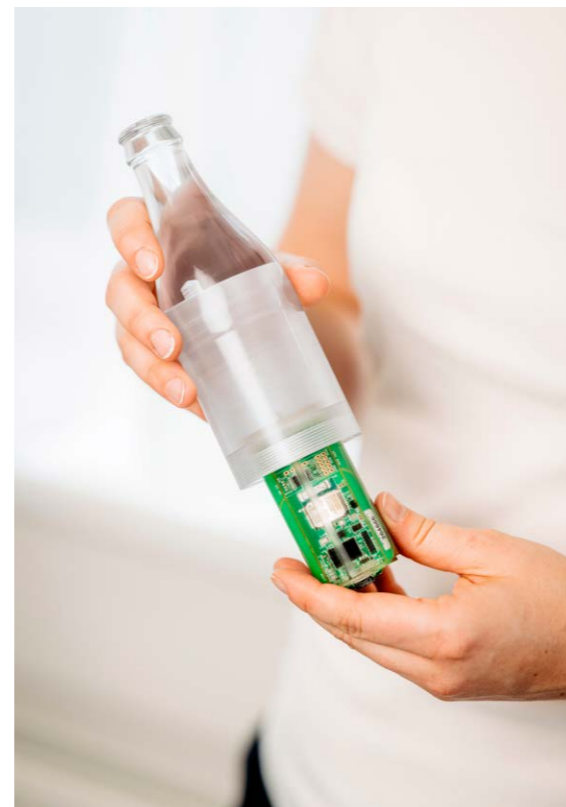
Il sensore inserito nel dummy rileva i punti potenzialmente a rischio per i contenitori di vetro in linea.
