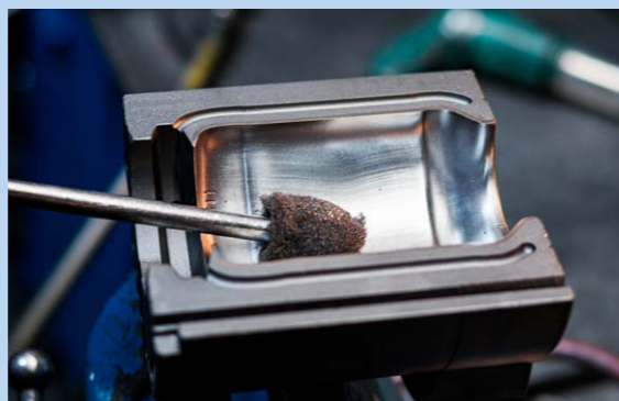
Immagine in alto: Per le sue specialità tipiche come la salsa di pomodoro alla paprika letcho, Lutsk Foods usa vasi di vetro Vetropack da 430 ml. Immagine a destra: prima di essere utilizzati, gli stampi vengono preparati per la produzione, puliti, lucidati e controllati.
