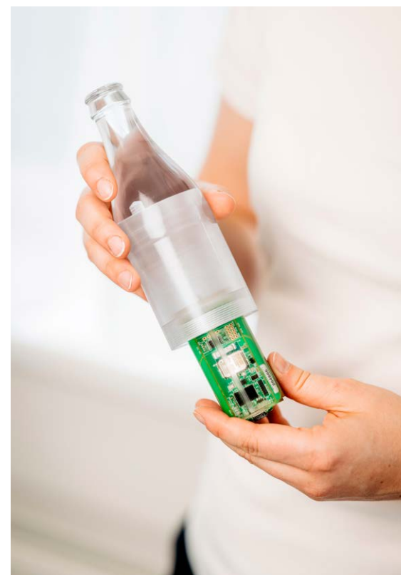
Der in den Dummy eingesetzte Sensor registriert mögliche Gefahrenpunkte für den Glasbehälter auf der Linie.
