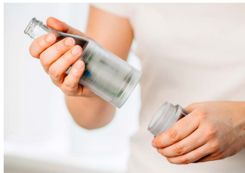
Der in den Dummy eingesetzte Sensor registriert mögliche Gefahrenpunkte für den Glasbehälter auf der Linie.
