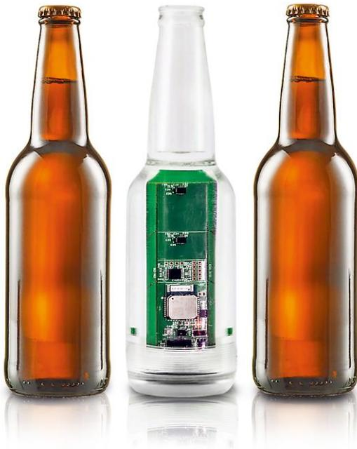
Bild 2: Mit in Kunststoffnachbildungen eingebetteten Sensoren prüft Vetropack für Kunden, ob Gläser und Flaschen in der Abfülllinie zu hohen Belastungen und Stößen ausgesetzt sind.
